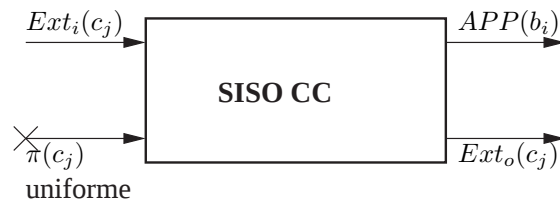
FIG. 4.10: Diagramme d'un module SISO du code convolutif
